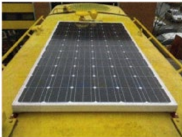
Рисунок 2 – Солнечная батарея, установленная на капоте Janine
