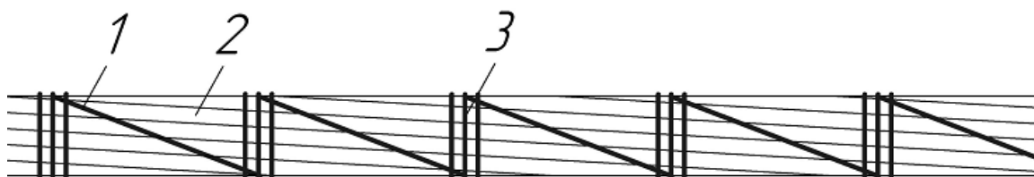
Рисунок 1 – Проволочный гаситель автоколебаний
