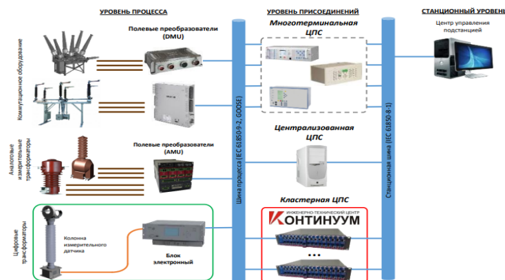
Рисунок 1 – Структура цифровой подстанции
