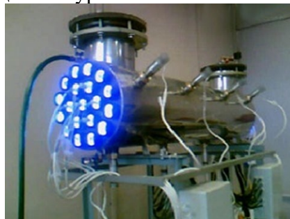
Рисунок 2 – очистка воды при помощи ультразвука
